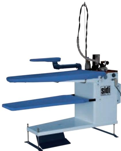
Table de repassage aspirante-chauffante. Reglable en hauteur manuellement de 930 mm. a 750 mm. Aspiration très puissante avec aspirateur majoré incorporé dans la table, fonctionnement par pédale. Commutation manuelle de l'aspiration pour table ou jeannette. Chauffage électrique du plateau réglable par thermostat. Possibilité d'installer 1 bras avec jeannette.
