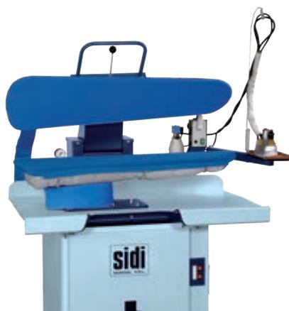
Presse manuelle universel avec molletton et housse. Abaissement du plateau superieur par pédale pour un utilisation et entretien très simple. Les deux plateaux sont vaporisant et le plateau inferieur aspirant . Disponible soit en version autonome ou soit a raccorder sur vapeur et vacuum centraux . La chaudière incorporée peut etre renforcée pour alimenter une autre machine ..
